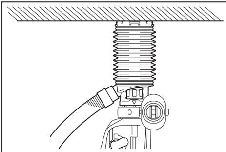
**OBSERVAÇÃO:** Não use o conjunto do coletor de pó para perfuração em metal ou semelhantes. O conjunto do coletor de pó pode ser danificado pelo calor produzido pela poeira metálica ou semelhantes.
