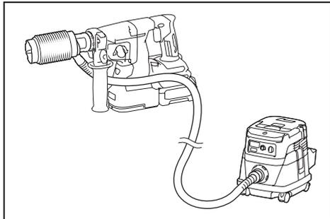
3. Coloque o interruptor do modo de espera do aspirador na posição "AUTO".
