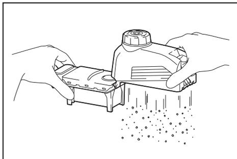
**OBSERVAÇÃO:** Quando limpar o filtro, bata delicadamente no reservatório deste com a mão para remover o pó. Não bata no filtro diretamente, não toque no filtro com uma escova ou semelhante, nem use jatos de ar comprimido. Fazer isso poderia danificar o filtro.
