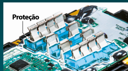
Estrutura de proteção dos circuitos e terminais
